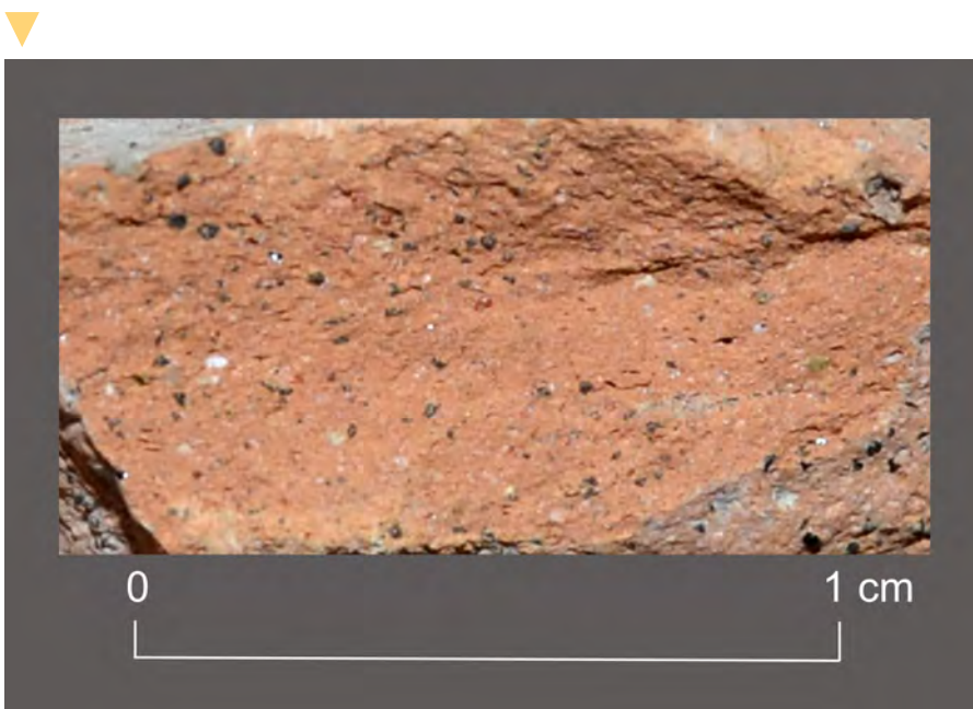
Figura 2. Macrofotografía de la pasta cerámica del ánfora en fractura nueva.
